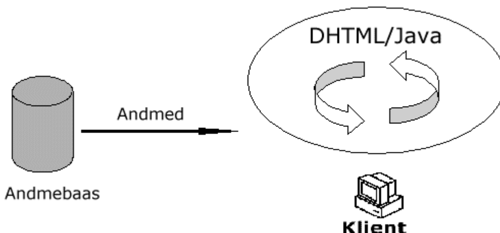
Joonis 4.2 Kahekihiline veebiinfosüsteem
